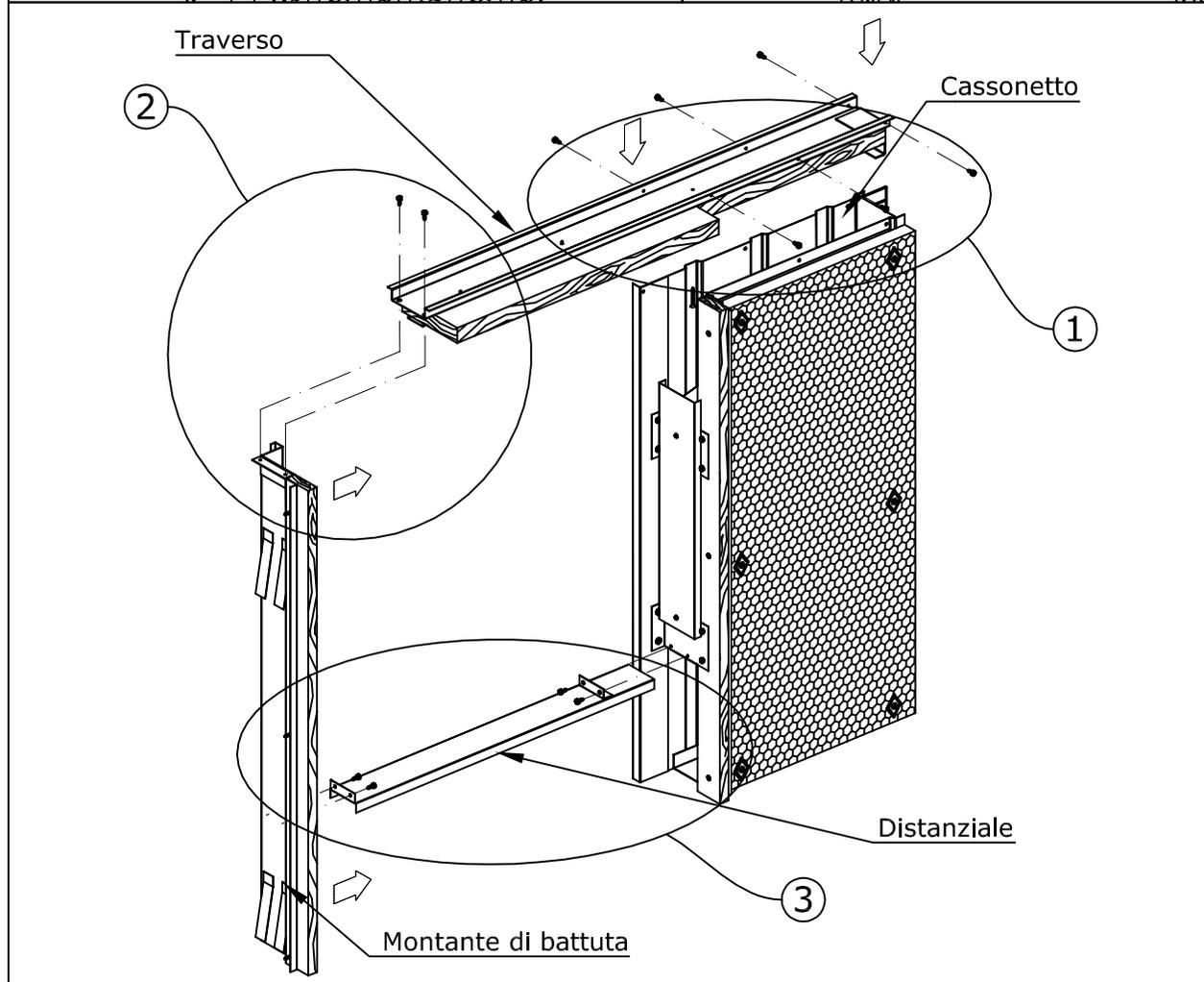
**Istruzioni per il montaggio e la posa in opera del control telaio IRIDE**
